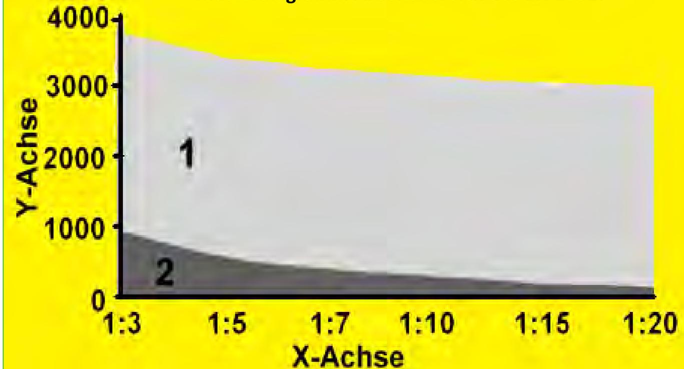
Die Y-Achse zeigt den Nennförderstrom in l/min an. Die X-Achse gibt die einstellbaren Verhältnisse (Flüssigkeit/Luft) an. 2 gibt den bei einem bestimmten Verhältnis geförderten Volumenstrom WS- Gemisch in l/min an. 1 zeigt den Volumenstrom Luft ebenfalls in l/min.
