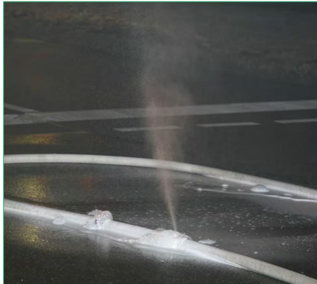
*Druckluft entweicht durch Undichtigkeit. Es kommt zu Schaumbblasenbildung*
