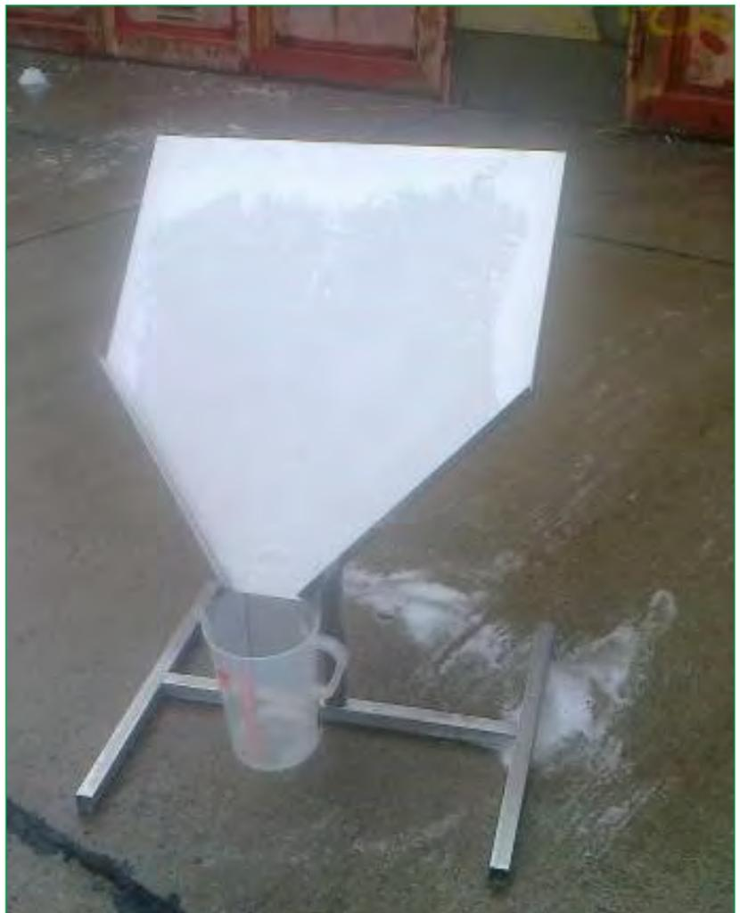
*Das Bild zeigt die Auffangvorrichtung nach EN 1568. Der Schaumstrahl ist auf die Fläche abregnen zu lassen, dazu wird der Abstand zum Strahlrohr entsprechend angepasst.*
