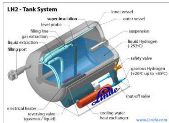
Abb. 4: Flüssigwasserstofftank (Liquid Hydrogen Tank, LH 2 ) 6
