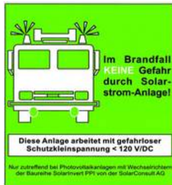
Bild 2: Beispiel zur Kennzeichnung der Schutzkleinspannung. (Quelle: Brandschutz Deutsche Feuerwehr-Zeitung 11/10)
