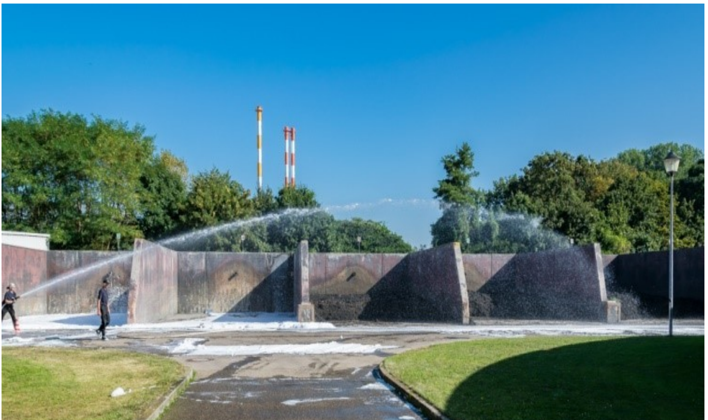
Wasser bei einem Ausgangsdruck von 7 bar. Die Wurfweite beträgt zirka 25 Meter bei einem Volumenstrom von 400 l/min
