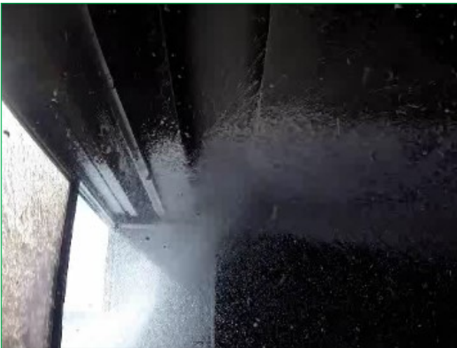
Kalte Lage. Der Strahl trifft an die Decke und wird reflektiert.
