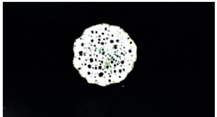
Nach der Kollision wird die Dispersion auf der Fläche verteilt und bleibt haften. Aus Volumen wird Fläche.
