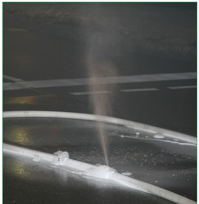
Druckluft entweicht durch Undichtigkeit. Es kommt zu Schaumblasenbildung
