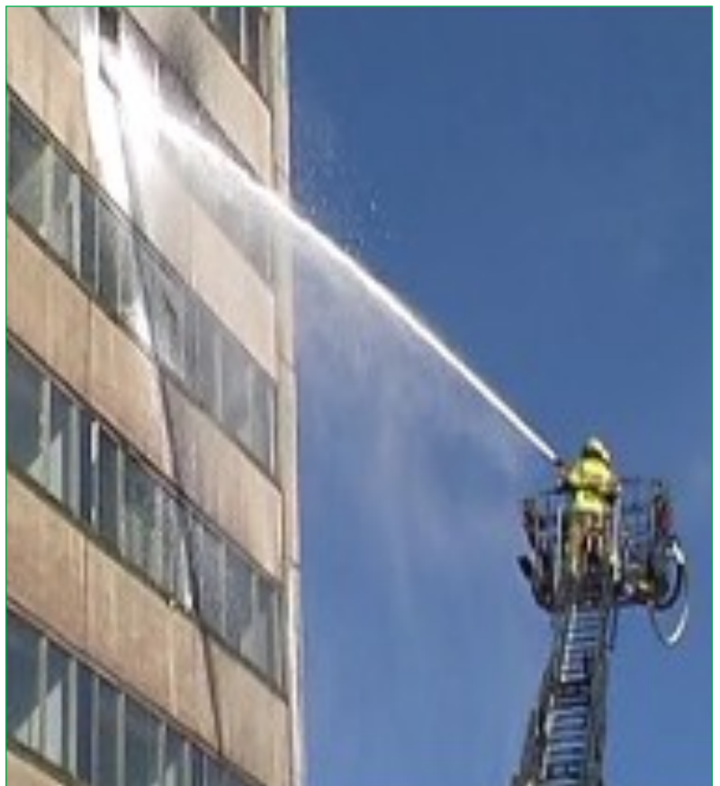
Hier wird ein Hohlstrahlrohr vom Korb einer Drehleiter für den Außenangriff eingesetzt.
