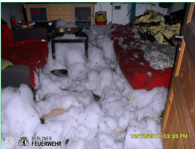
Schaumberge entstehen vor allem durch die gleichzeitige Verwendung von Schaum und Wasser
