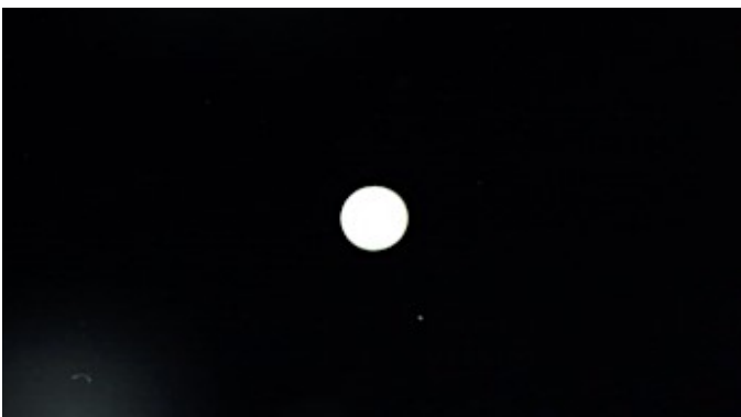
Ein Schaumteil in Kugelform fliegt auf die auf 130°C erwärmte Glasscheibe zu.
